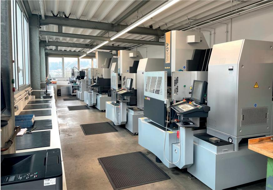
Bild 3: Phalanx an neuen EDM: gleich fünf Erodiermaschinen stehen neu im Formenbau der Zinkgießerei Wissler & Rademacher
